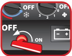
**4/** Stopper le moteur / isoler la batterie en activant l'interrupteur général quand c'est possible. Couper la climatisation / le chauffage.
