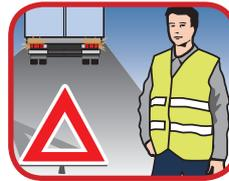
**8/** Endosser le gilet réfléchissant et disposer correctement au sol les panneaux d'avertissement / Sécuriser la zone de l'incident.
